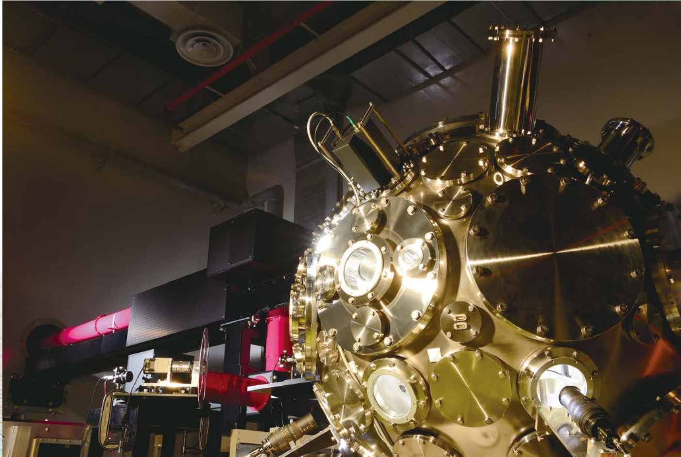
産業開発研究センターに設置されたレーザーフュージョン実験用チャンバー(手前)
